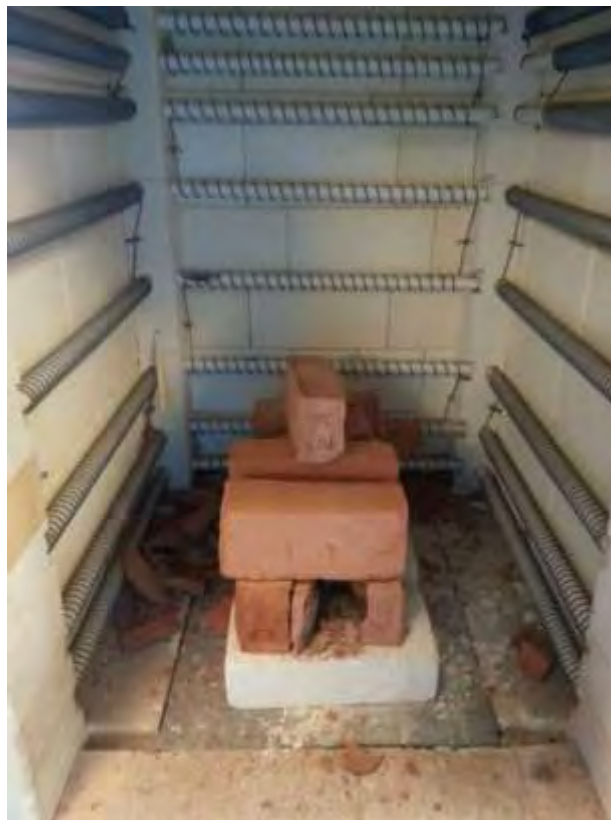
FIGURE 48 - BRICKS IN MIT KILN AFTER FIRING
